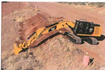
Zeppelin stellt den neuen Bagger Cat 323F L mit seinem verstärkten Aufbau und den massiven Kontergewichten vor. Dank eines schwereren Kontergewichts soll der 323F L eine um 8% höhere Traglast bieten und ist so für eine große Bandbreite an Arbeitsgeräten wie Schwenklöffel, Tiltrotatoren, Hämmer und Scheren geeignet.
