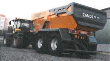
Mit dem Tandem-Dumper TD 240 präsentiert Zandt ein neues Tandemkipper-Konzept für leistungsstarke Traktoren. Neben Aufgaben im Erd- und Tiefbau ergeben sich durch die belastbare Dumpermulde Einsatzspektren im Abbruch und bei der Entsorgung.
